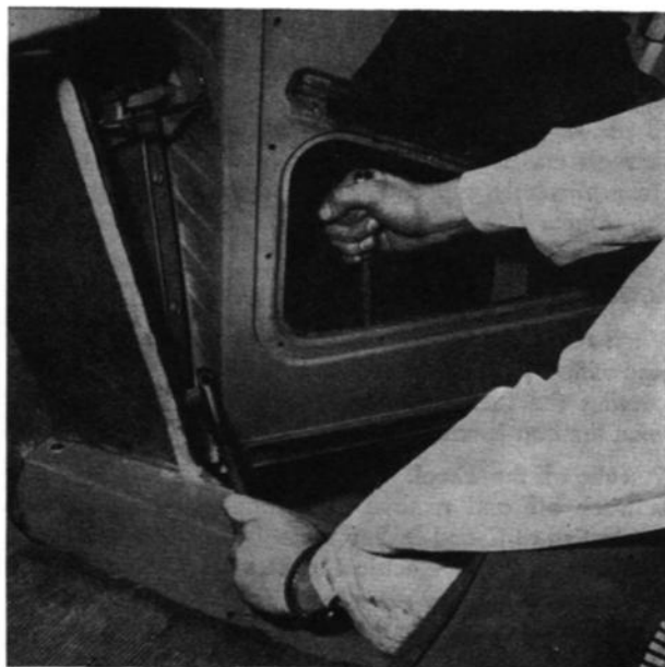
INSTALLING A DOOR
